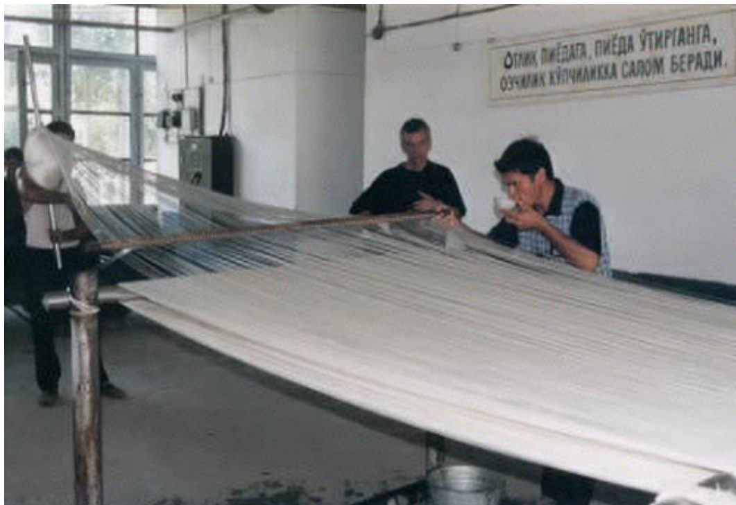
L'enroulement et l'encollage de la chaîne
